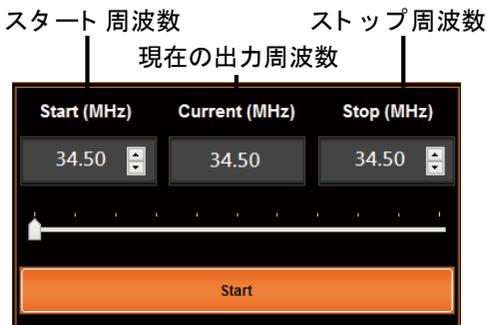
**周波数表示バー** START ボタンを押すと、出力を開始し周波数ステータスバー上の点がスイープ出力の現在出力している周波数位置を示します。STOP ボタンを押すと、ステータスバーの点は開始位置に戻ります。周波数を停止することができます。
