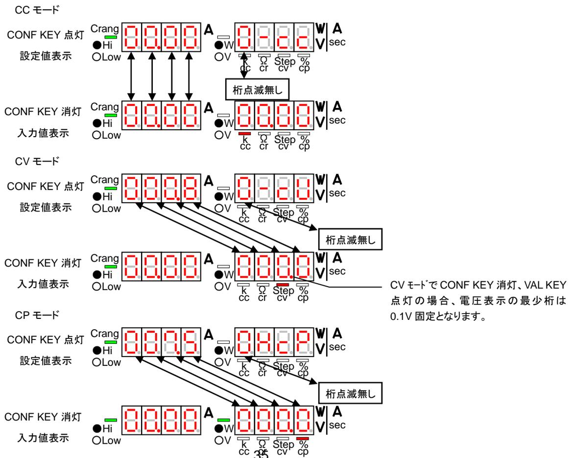
3. 操作 2 の状態から、DIGIT KEY を操作すると A 表示部又は V・W 表示部の点滅桁は左右に移動します。
