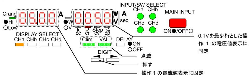
3. 操作 2 から VAL KEY を押すと、VAL KEY 点灯、C-lim KEY 点滅、V・W 表示部は 1 桁目が点滅状態となります。この状態でロータリーエンコーダにより V・W 表示部に表示されている電圧値を点滅している桁で増減できます。また、DIGIT KEY により点滅桁を移動できます。
