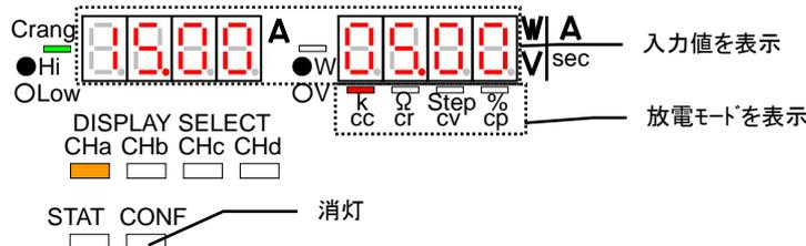
設定値表示: CONF KEY を押して点灯とすると、A 表示部と V・W 表示部には設定値、放電モードが表示されます。また、放電モード/単位表示 LED は、設定値の単位を表す LED が点灯します。
