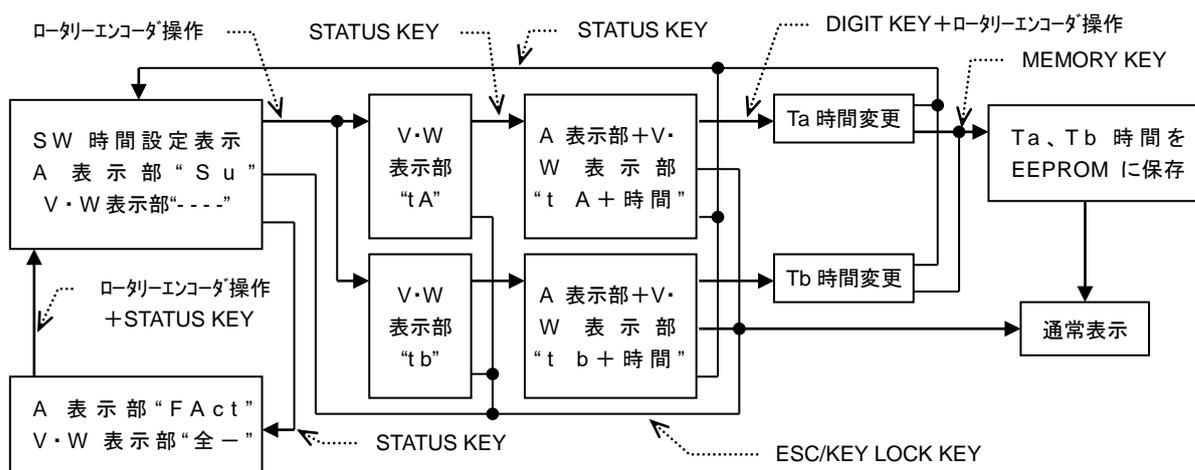
1. スイッチング時間設定表示からロータリーエンコーダを時計方向に操作すると、V・W 表示部は“t A”と“t b”を交互に表示します。
