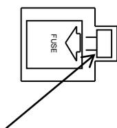
この部分を図の矢印方向に押し取り外します。
