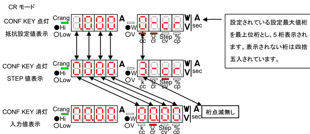
3. 操作 2 の状態から、DIGIT KEY を操作すると A 表示部又は V・W 表示部の点滅桁は左右に移動します。左 DIGIT KEY を押すと点滅桁は左に移動し、右 DIGIT KEY を押すと点滅桁は右に移動します。
