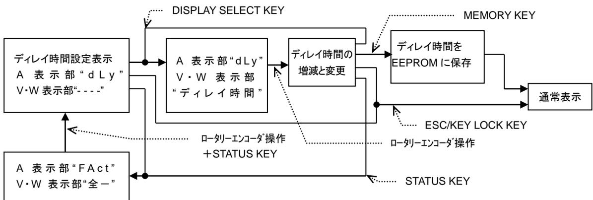
1. 遅延時間設定表示から、遅延時間設定したいチャンネルの DISPLAY SELECT KEY を押すと、押さ
