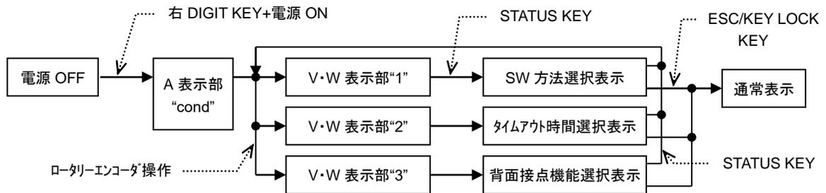
1. 電源OFFから、右DIGIT KEYを押しながら電源をONすると、A表示部は“c o n d”、V・W表示部は“1”表示となります。
