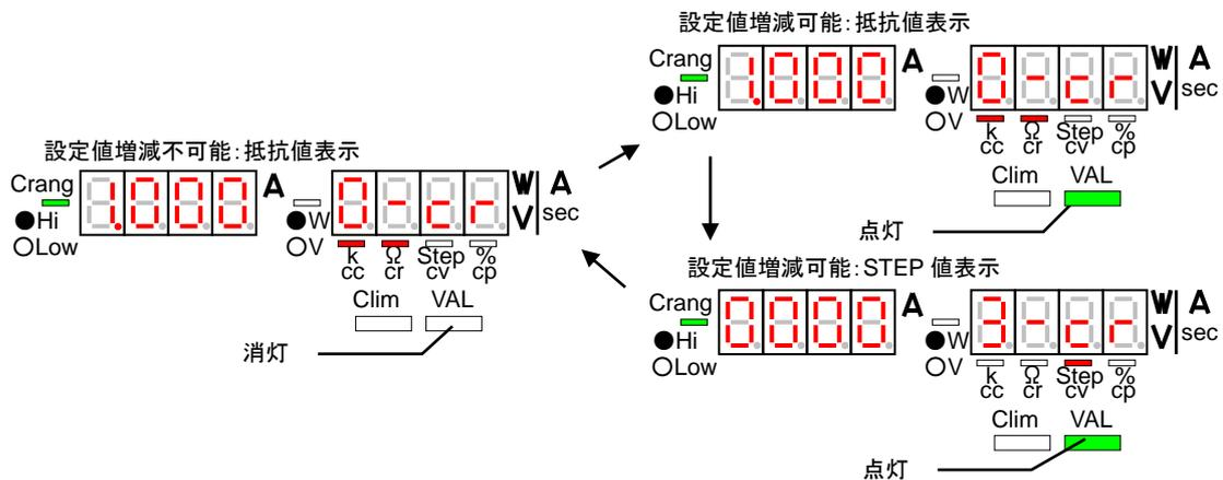
2. VAL KEY を点灯状態とすると、本機の A 表示部と V・W 表示部の桁が点滅状態となります。但し、CONF KEY 消灯で、設定値増減桁が設定値の最少桁の場合、設定値増減桁の桁点滅はありません。各表示状態での点滅桁は以下のようになります。
