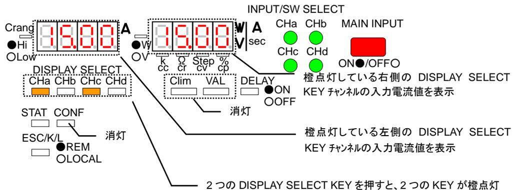
・CONF KEY、VAL KEY、C-lim KEY を消灯状態で、2つの DISPLAY SELECT KEY を押して2つの DISPLAY SELECT KEY を橙点灯とすることで、左橙点灯している DISPLAY SELECT KEY チャンネルの入力値を A 表示部に、右橙点灯している DISPLAY SELECT KEY チャンネルの入力値を V・W 表示部に表示する事ができます。
