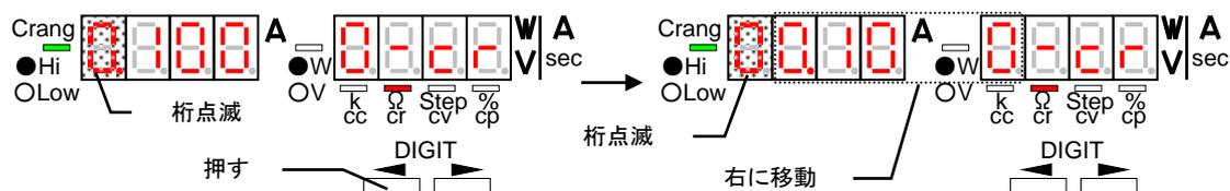
点滅桁が一番右の桁で、現在設定されている設定値最上位桁が 4 桁目より下の桁にある場合、右 DIGIT KEY を押すと桁全体が 1 桁ずつ左にシフトし、表示されていた 4 桁目の下の桁を 1 桁目として桁点滅します。
