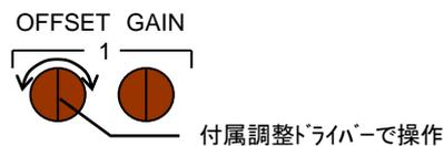
4. 外部電圧を 9V とします。調整ボリューム GAIN 側を操作し、A 表示部と V・W 表示部に表示される値を、各放電モード定格値の 90% とします。CR モードの場合は“27000”(STEP 値)として下さい。
