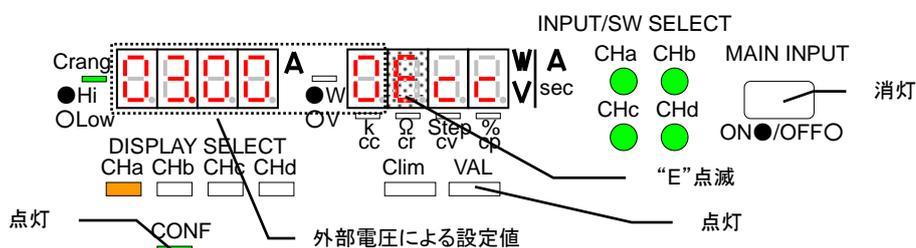
3. メインインプットを ON すると、操作 1 と操作 2 で設定電流値の加算された電流値が本機に流れます。
