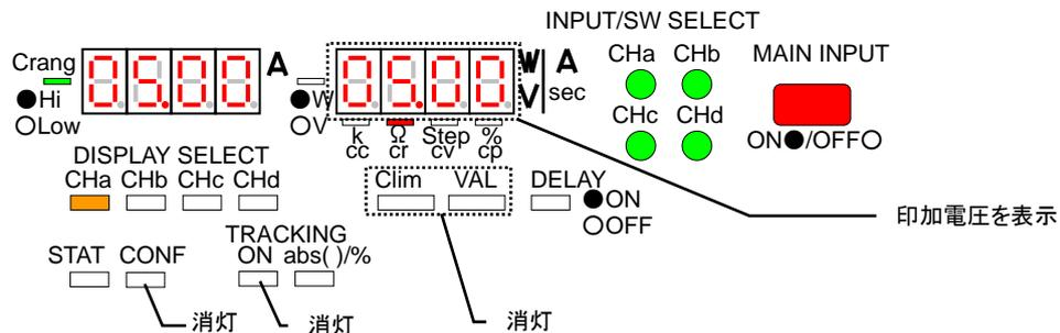
2. 操作 1 から左 DIGIT KEY を押すと、VAL KEY 点滅、C-lim KEY 点滅、A 表示部は操作 1 の表示値に固定、V・W 表示部は 0.1V を最少桁とした操作 1 の表示値に固定されます。また、電圧表示は 0.01V の桁は切り捨てられた表示となります。
