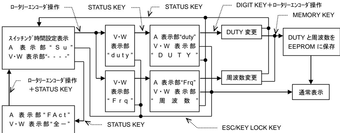
1. スイッチング時間設定表示からロータリーエンコーダを時計方向に操作すると、V・W 表示部は“d U t y”と“F r q”を交互に表示します。
