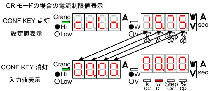
定電圧モード時の電流制限モード表示(下図左)と、定電力モード時の電流制限モード表示(下図右)は以下となります。
