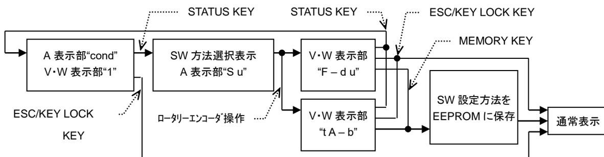
1. スイッチング方法選択表示(A表示部は“S u”、V・W表示部は“F - d u”又は“t A - b”)からロータリーエンコーダを操作すると、V・W表示部は“F - d u”→“t A - b”→“F - d u”...となります。
