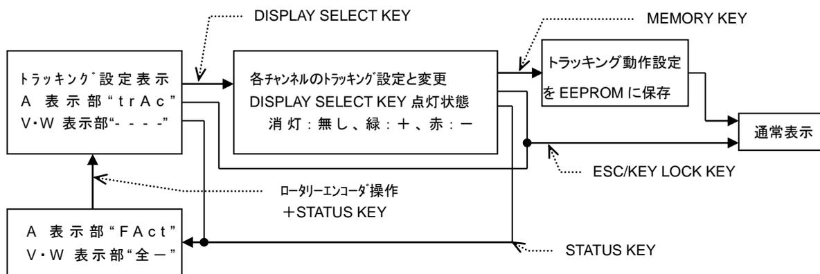
本操作で、全 DISPLAY SELECT KEY は現在設定されているトラッキング設定状態の点灯となっています。DISPLAY SELECT KEY 点灯状態の意味を以下に記載します。
