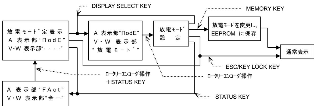
1. 放電モード設定表示から、放電モードを変更したいチャンネルの DISPLAY SELECT KEY を押すと、押された DISPLAY SELECT KEY は緑点灯となります。この時、V・W 表示部には現在設定されている放電モードが表示されます。
