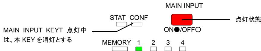
2. 別の放電モードと設定値を設定した PRESET KEY を押し、その PRESET KEY を緑点灯とします。これにより、本機各チャンネルの放電モードと設定値は緑点灯している PRESET KEY の内容となります。
