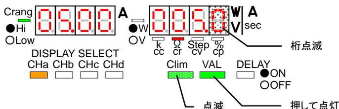
4. 操作 2、3 から C-lim KEY を押すと、C-lim KEY 点灯、VAL KEY 点滅、A 表示部は 1 桁目が点滅状態となります。この状態でロータリーエンコーダにより A 表示部に表示されている電流値を点滅している桁で増減できます。また、DIGIT KEY により点滅桁を移動できます。
