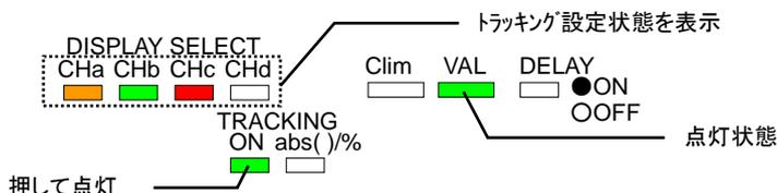
4. TRACKING ON/OFF KEY が点灯からKEYを押すとKEYは消灯し、トラッキング動作はOFFとなります。
