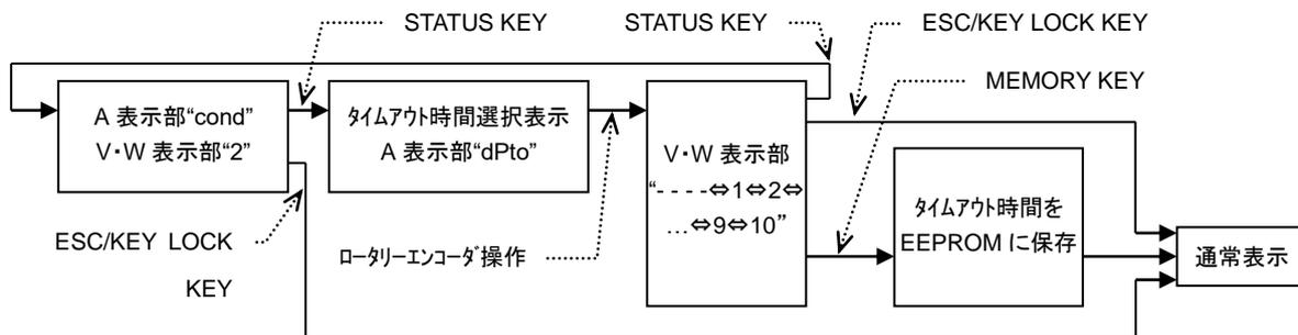
1. タイムアウト時間選択(A表示部は“d P t o”、V・W表示部は“— — — —、1、2...9、10”の何れか)からロータリーエンコーダを操作すると、V・W表示部は“— — — —”⇔1⇔2...9⇔10表示となります。
