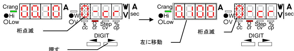
4. ロータリーエンコーダを操作して、点滅桁の数値を増減します。ロータリーエンコーダを時計方向に操作すると、点滅桁で設定値は増加します。ロータリーエンコーダを反時計方向に操作すると、点滅桁で設定値は減少します。
