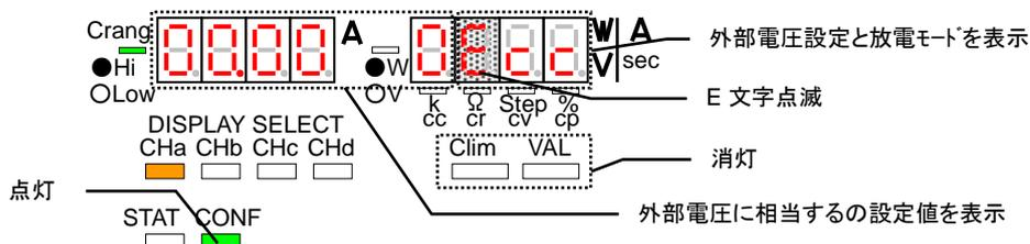
3. J2 に外部電圧を接続し、外部電圧を 1V とします。調整ボリューム OFFSET 側を操作し、A 表示部と V・W 表示部に表示される値を、各放電モード定格値の 10% とします。CR モードの場合は“3000”(STEP 値)として下さい。
