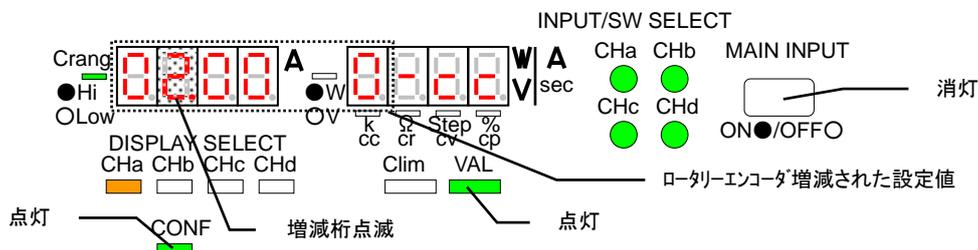
2. 任意の外部電圧を本機 J2 に印加します。CONF KEY 点灯、VAL KEY 消灯とすると A 表示部と V・W 表示部に外部電圧による設定値が表示されます。
