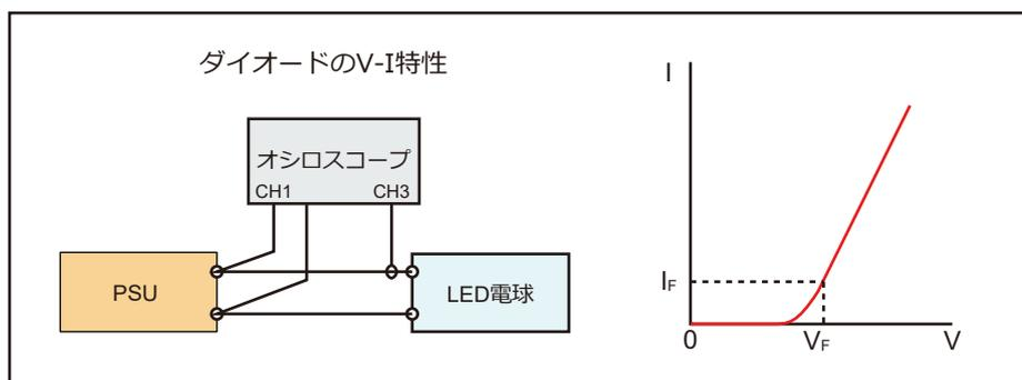
定電圧 (CV)優先モードと定電流 (CC) 優先モードを選択することが可能です。例えばOUTPUT ON時に定電流動作となる負荷 (LED等) を立ち上げる際の電流オーバーシュートを、当社独自の抑制回路により一般のスイッチング電源より小さくできます。
