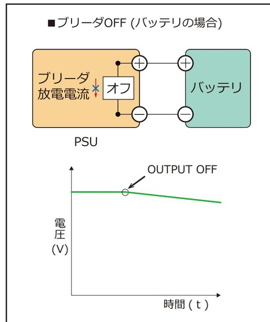
本器には出力端にコンデンサが接続されており、OUTPUT OFF時にその電荷を放電させるためのブリーダ回路が搭載されています。ブリーダ回路をOFFすると、出力OFF時に接続されているバッテリーやコンデンサの電荷の放電を少なくできます。
