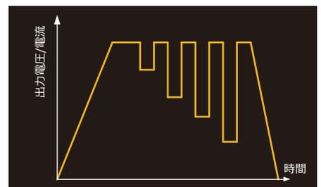
時間に合わせて、電圧、電流設定値を自動更新させるテスト機能を装備しております。電圧・電流値、時間などの数値をCSVファイルで編集し、USBメモリを介して本体に読み込ませ実行することができます。CSVファイルは10個まで保存できます。
