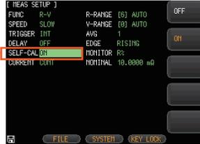
自己校正機能は、内部回路のオフセット電圧とゲインドリフトを除去し、測定精度を向上させます。測定速度 Slow では常に自己校正を実行します。Medium 以上の測定速度では、自己校正機能が ON の場合、自動的に 30 分毎に校正を行います。外部トリガの場合自己校正は自動で実行されません。ハンドラの校正実行端子の制御で実行が可能です。
