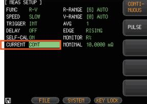
出力電流を連続と PAUSE の切り替えが可能です。本器を複数台並べて測定する場合、測定信号が交流のため互いに干渉する場合があります。出力電流モードを PAUSE にすると測定信号出力を測定時のみにしますので、相互干渉を極力少なくすることができます。
