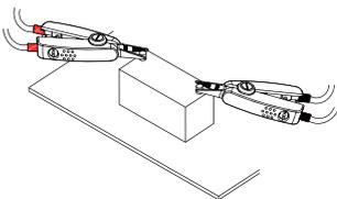
高分解能測定には、テストリードを電池などに確実に接続する必要があります。接触不良やテストリードが断線している場合など、正しく測定できていない状態を検出してアラート表示します。
