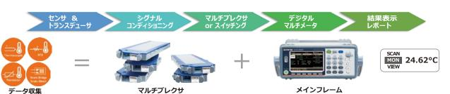
3つのモジュール・スロットは、用途に合わせて各モジュールを自由に組み合わせることができます。各モジュールの測定チャンネルは、測定機能・範囲・速度などを個別に設定することが可能です。 ハーフラックで最大60の2線式測定、120のシングルエンド測定など、スペースやコストの削減に大いに貢献します。
