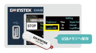
DAQ-9600は、100kの不揮発性メモリ容量により、PCに接続することなく測定結果を保存できます。測定結果を本体内に保存し、PCを接続してそのデータを取得することができます。また前面のポートにUSBメモリを挿入し直接記録することや本体からのデータコピーも可能です。
