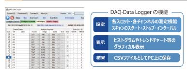
フリーで使用可能なPCソフトウェア DAQ-Data Loggerを提供します。LAN/USB/GPIBでPCと接続し、プログラミング不要で即データ収集/データロガーとして使用することができます。
