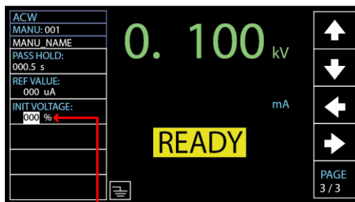
INIT VOLTAGE 設定カーソル
