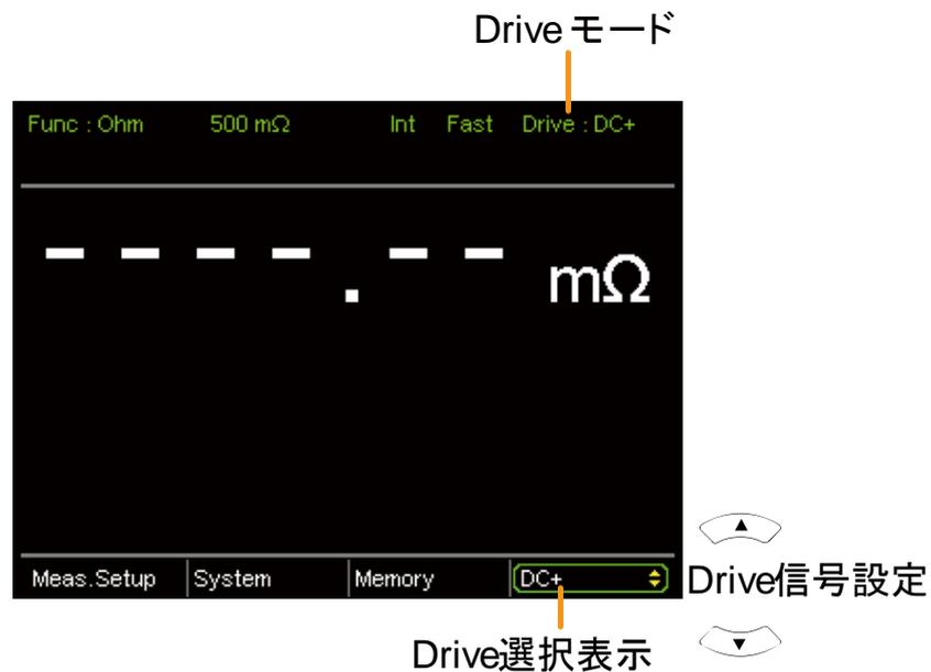
Drive 選択 DC+、DC-、Pulse、PWM、Zero、Standby
