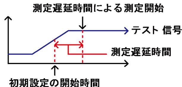
測定遅延時間を設定すると、初期設定の測定開始時間が最適ではない充電に時間を必要とするような部品を測定するのに有効です。
