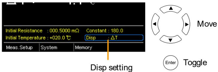
T には、DUT の測定された抵抗値における推定温度が表示されます。
