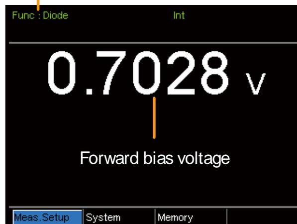
3. テストリードを接続し測定する                      アノードにソース+、センス+を接続します。
