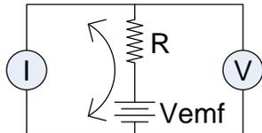
これは、DUT を挟んで正および負の測定電圧を生成します。これは  $V_{emf}(V1 + V_{emf}$  と  $V2 + V_{emf})$  を含んでいます。
