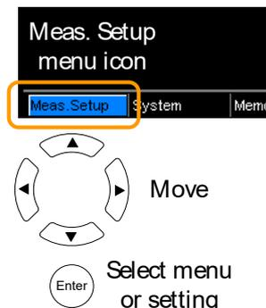
2. 測定遅延時間の矢印キーで Measure Delay をオンに遅延時間を設定します。Enter キーで設定を確定します。
