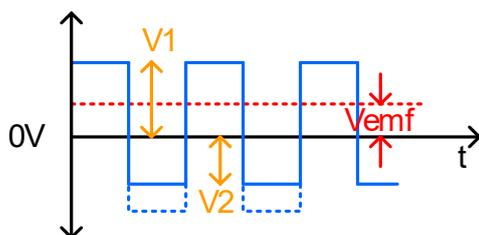
以下の式のように  $V_{emf}$  をキャンセルするには、 $V1$  から  $V2$  を差し引き、2 で割って平均測定を取得します:
