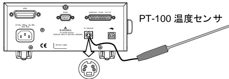
**!** 注意: 温度補償センサが接続されていない場合、周囲温度は、手動で設定する必要があります。
