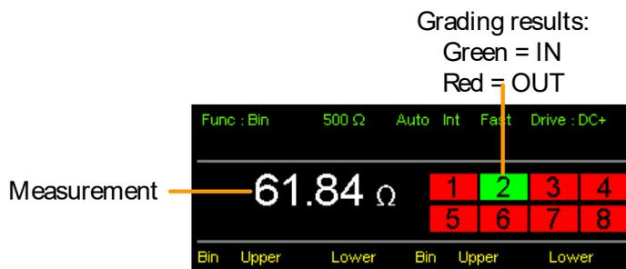
カウント表示モードは、画面右側に結果を集計し、左側に BIN 設定を表示しています。
