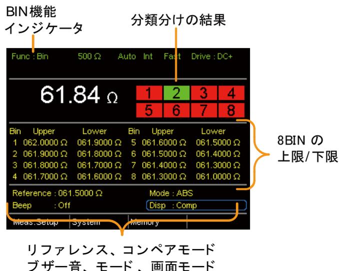
1. Bin 機能の選択 **Binning** キーを押し BIN 機能を選択します。
