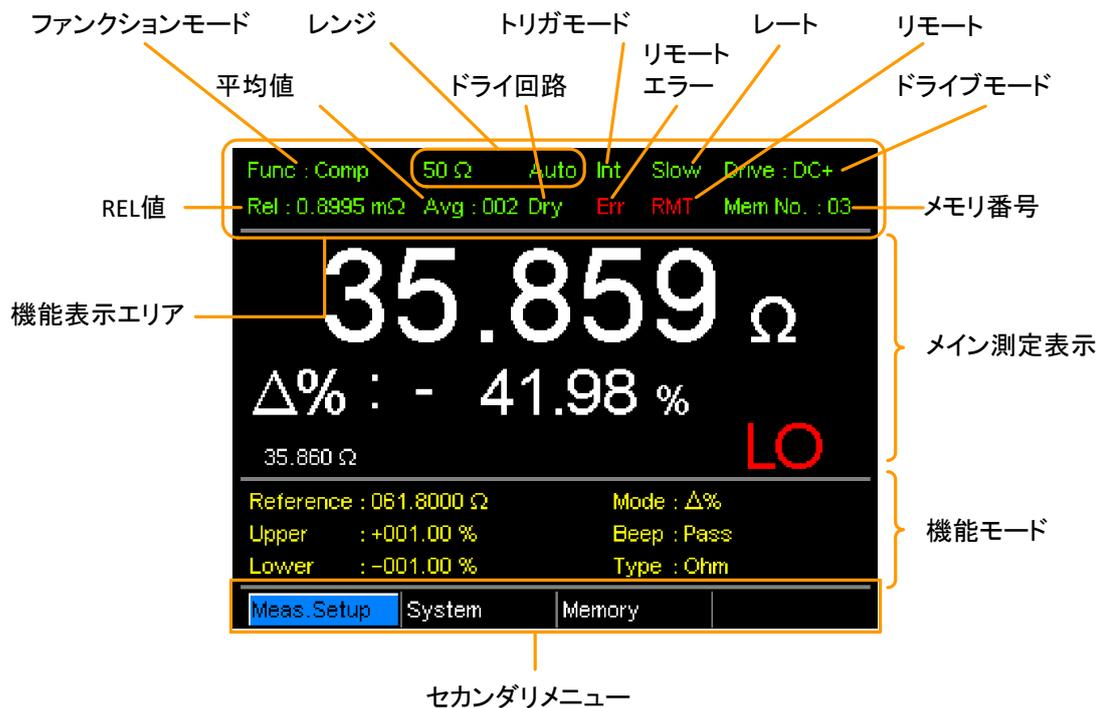
ファンクション制御インジケータ 機能制御インジケータは、選択しているファンクションモードの現在有効な設定を表示しています。
