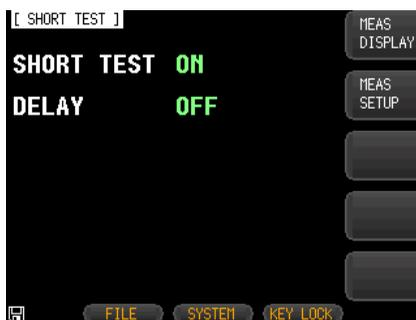
3. 矢印キーを使用して、[SHORT TEST] 画面の **SHORT TEST** 項目にカーソルを移動します。
