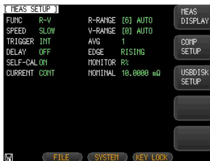
3. 画面の右側にある **USBDISK SETUP** のオプションキーを押します。
