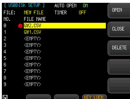
8. 開いているファイルを選択し、画面の右側にある **CLOSE** オプションキーを押してファイルを閉じます。ファイル名の前にある赤いドットが消え、画面の左下に「file closed」のメッセージが表示されます。
