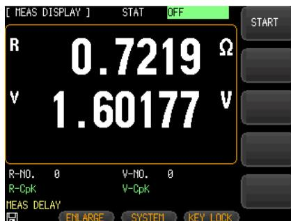
2. 画面の右側にある **START** オプションキーを押して、統計処理を開始します。データの統計は設定したバッファ数が満杯になるまで続きます。
