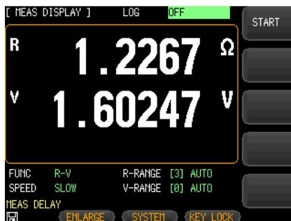
2. 画面の右側にある **START** オプションキーを押して、連続データログを開始します。データログ動作は設定したバッファ数が満杯になるまで続きます。
