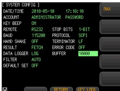
4. 数字キーで値を入力して Enter キーを押すか、画面の右側にある MAX オプションキーを押して、ログするデータ数を設定します。
