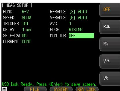
3. 画面の右側にあるオプションキーを使用して、パラメータを選択、または OFF のキーを押してモニタ機能を OFF にします。
