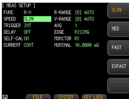
3. 画面の右側にあるオプションキーを使用して、所望の測定速度を選択します。
