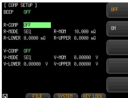
適用パラメータ OFF 抵抗/電圧コンパレータ各機能を無効にします。
