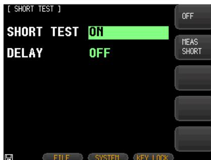
4. **MEAS SHORT** キーを押し、画面の右側にある **OK** オプションキーを押します。ショートテストの進行状況を確認できます。画面下部に“correction finished” が表示され完了します。
