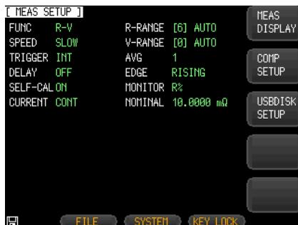
2. 矢印キーを使用して、**FUNC** 項目に反転ハイライトのカーソルを移動します。
